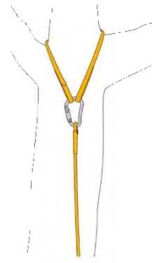
Fig. 5 - Ancoraggio della fune con dispositivo passante
